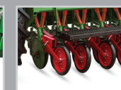
Roue de pression en caoutchouc pour planteur à double disque
